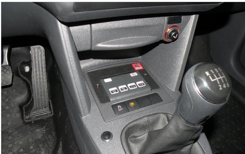
Le système programmable CanBus est la nouvelle génération d'unité de commande, qui dispose d'un interface PC, programmable librement. Les touches ont un rétro éclairage et un éclairage de fonction, les symboles peuvent être choisis librement (avec 64 pictogrammes livrés avec).
