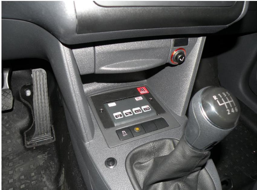
Le système programmable CanBus est la nouvelle génération d'unité de commande, qui dispose d'un interface PC, programmable librement. Les touches ont un rétro éclairage et un éclairage de fonction, les symboles peuvent être choisis librement (avec 64 pictogrammes livrés avec).
