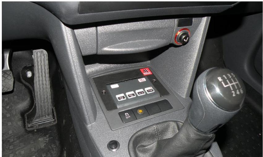
Das programmierbare Canbus-System ist die neueste Generation von Bedieneinheiten, welches über eine PC-Schnittstelle frei programmiert werden kann. Die Tastatur hat eine Hintergrund- und Funktionsbeleuchtung, die Symbole können frei gewählt werden (mit 64 mitgelieferten Tasten-Piktogrammen).
