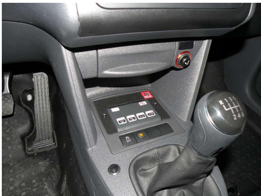
Dernière génération de boîtier de commande CANBUS aux possibilités infinies, programmables librement par l'interface PC et comprenant 50 sorties statiquement sécurisées avec éclairage des fonctions et du clavier. Le module est livré avec 64 pictogrammes de fonctions.
