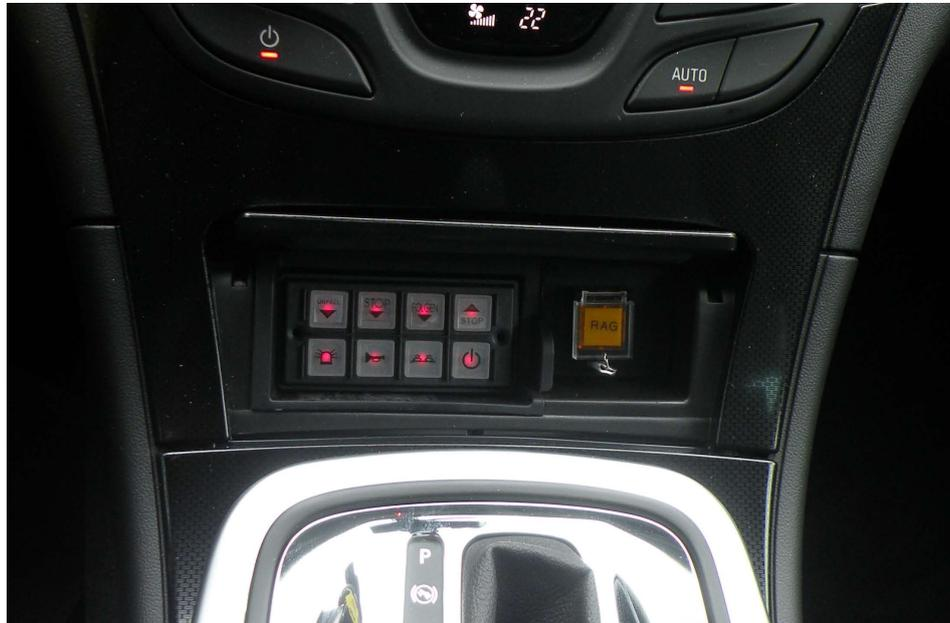
La solution au manque récurrent de place dans les véhicules d'intervention actuels se trouve dans le boîtier de commande TiNY8. Sa construction compacte lui permet de s'encaster pratiquement partout.
