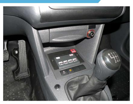
Dernière génération de boîtier de commande CANBUS aux possibilités infinies, programmables librement par l'interface PC et comprenant 50 sorties statiquement sécurisées avec éclairage des fonctions et du clavier. Le module est livré avec 64 pictogrammes de fonctions.
