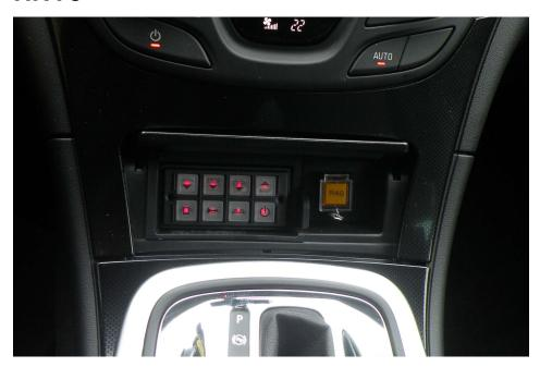
La solution au manque récurant de place dans les véhicules d'intervention actuels se trouve dans le boîtier de commande TiNY8. Sa construction compacte lui permet de s'encastrer pratiquement partout.
