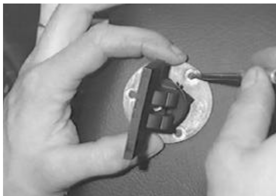
Abb 6: Markieren der Bohrungen unter Verwendung des runden Unterteils als Schablone
