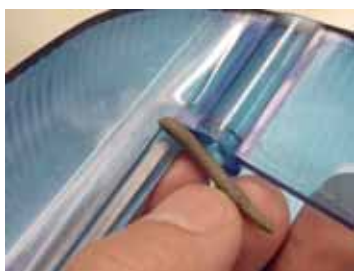
Fig 1. Se tomará una porción de sellador Ref. 9040150 y se hará una figura tubular.
