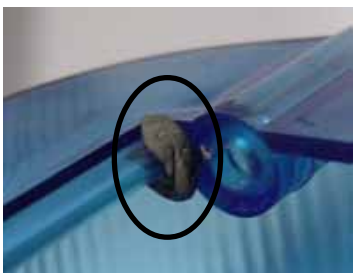
Fig 2. Se envolverá la guía de la lente con dicho sellador justo en la parte donde se atornilla.
